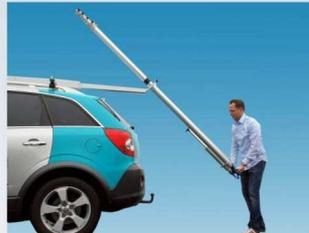
Kippmechanismus zur Montage des Hochstativs ohne Dreibein auf einem PKW. Nach dem Zurückziehen wird das Hochstativ auf der Anhängerkupplung fest verankert. Es kann aber auch mit wenigen Handgriffen für Indooraufnahmen abgenommen werden.
