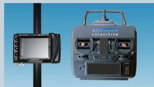
Der Empfänger mit 3,5" Farb-Monitor für die Bildübertragung kann direkt an das Hochstativ geklemmt oder aus der Hand bedient werden. Der Empfänger hat einen Chinch-Ausgang, an dem ein größerer Monitor angeschlossen werden kann. Die Reichweite für Bildübertragung und Steuerung beträgt ca. 80 Meter. Ladegeräte für alle Akkus gehören zum Lieferumfang.
