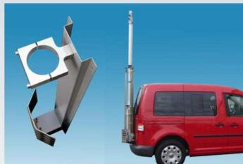
Befestigungsvorrichtung für die Montage des Hochstativs am Heck eines passenden Fahrzeuges. Mit wenigen Handgriffen kann das Hochstativ wieder abgenommen werden.
