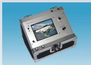
Steuereinheit mit ergonomisch geformter Bedieneroberfläche. Über Joystick und beleuchtete Taster werden alle Bewegungen der Kamera incl. Auslösung der Kamera gesteuert. Ausgestattet mit einem 8,4 Zoll Farbmonitor und einem Akku für lange Betriebszeiten. Mit Stecker für externen Stromanschluß und Ladegerät.
